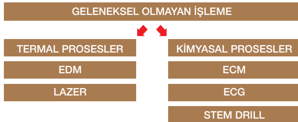
Şekil.1 TEI'deki Non-Conventional Machining Prosesleri
