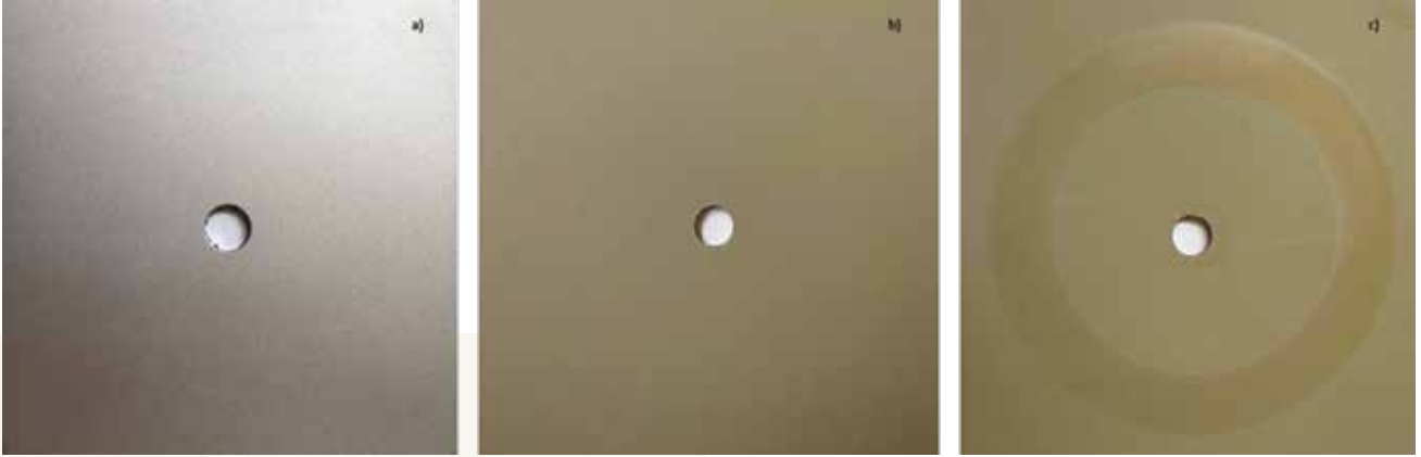
Resim 1. AA 7075 alüminyum alaşımı numuneler; a) kaplamasız, b) sert eloksal kaplama üzeri PTFE emprenye uygulanmış, c) sert eloksal üzeri PTFE emprenye sonrası Taber® abrasif aşınma testine tabii tutulmuş.
